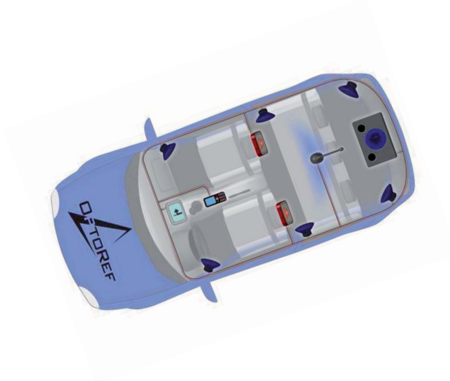
Abbildung 1.1: Einsatz der POF als Übertragungsmedium im Automobil
