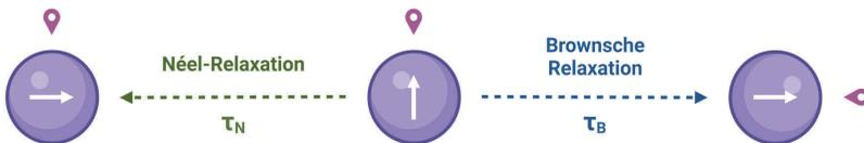
Abbildung 1.3: Schematische Darstellung der Relaxationsmechanismen von magnetischen Nanopartikeln. Modifiziert nach Lu et al., 2021.<sup>4</sup>
