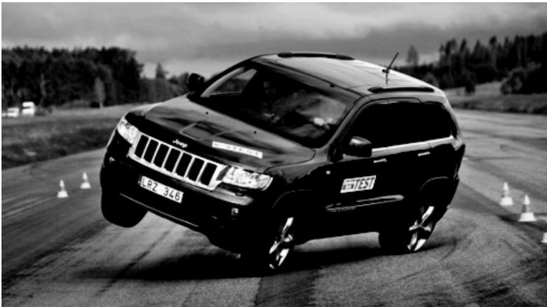
Abbildung 1.3: Die Radabhebung von einem Beispielfahrzeug beim Elchtest [VL12]
