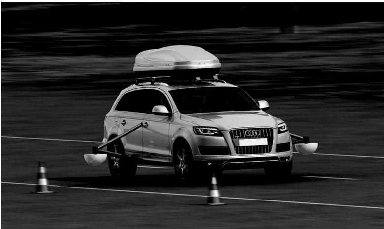
Abbildung 1.5: SUV mit Dachbeladung und Kippgestell [Cha+19a]
