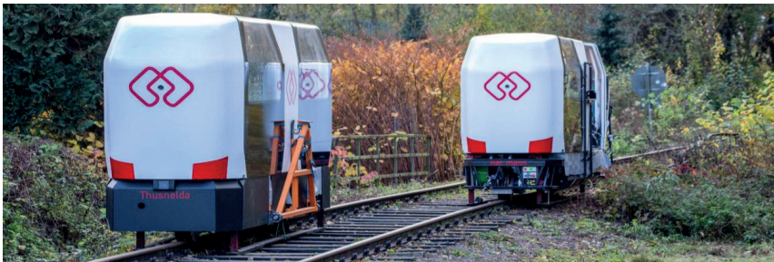
Bild 3: Automatisiert fahrende MONOCABs als eine ergänzende OnDemand-Mobilitätslösung zur Reaktivierung von Bahnstrecken
