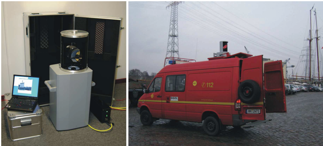
Abbildung 4: Fernerkundungssystem SIGIS 2. Links: SIGIS 2-System. Rechts: System in einem Messfahrzeug der Feuerwehr Hamburg.
