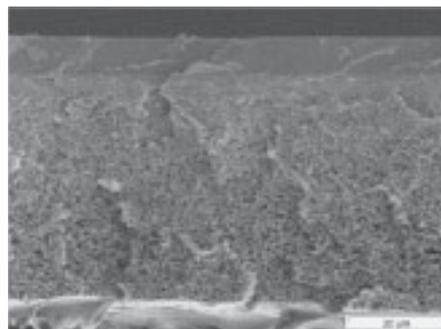
Abbildung 2.3: REM-Aufnahme eines Querschnitts durch eine Kompositmembran bestehend aus einer dünnen Polyelektrolyttrennschicht auf einer PAN/PET-Stützmembran (nach [23]).
