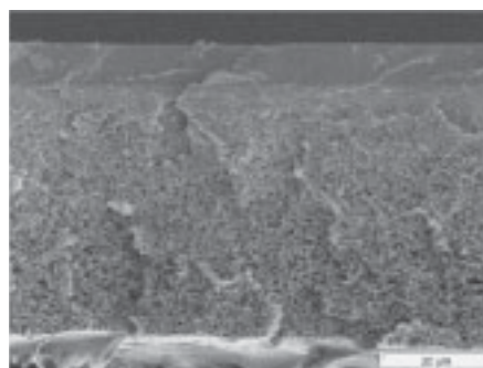
Abbildung 2.3: REM-Aufnahme eines Querschnitts durch eine Kompositmembran bestehend aus einer dünnen Polyelektrolyttrennschicht auf einer PAN/PET-Stützmembran (nach [23]).
