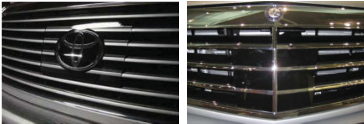
(a) Markenplakette als Radom beim Toyota Crown (b) Radom im Kühlergrill der Mercedes E-Klasse
