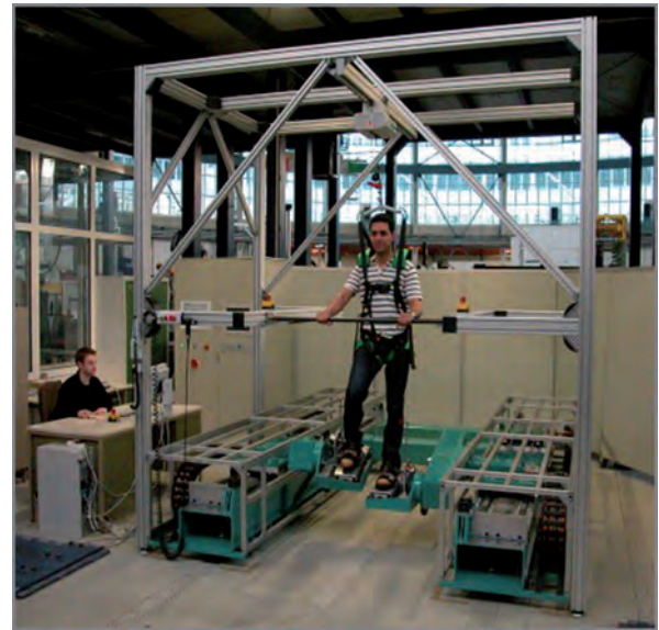
Abb. 1.2: Robotergestützter Laufsimulator HapticWalker des Fraunhofer IPK ( http://www.hapticwalker.de )
