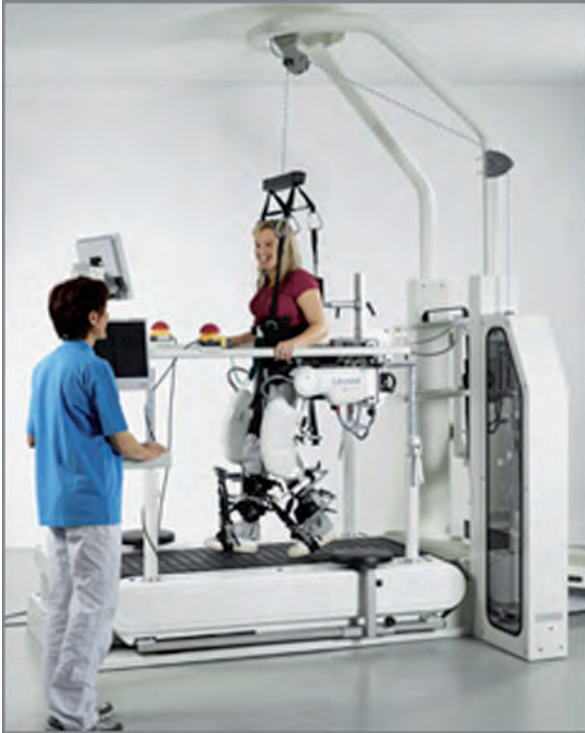
Abb. 1.3: Robotergestützte Gangorthese Lokomat ( http://www.hocoma.ch )
