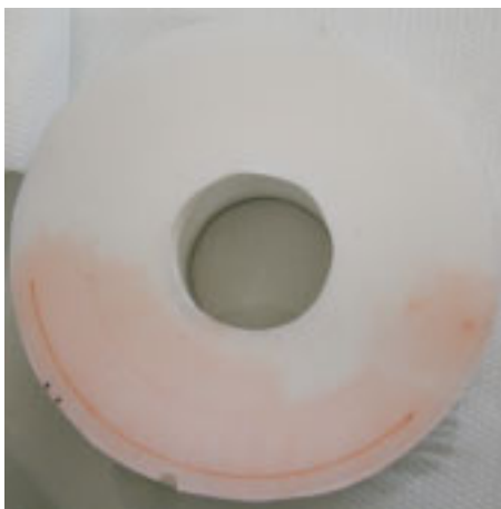
Abbildung 3.4: Eine Membran, die schlecht abgedichtet war. Die Flüssigkeit konnte sich auch außerhalb des Kanals ausbreiten.
