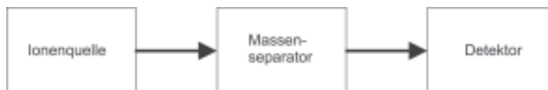
Abbildung 2.2: Prinzipieller Aufbau eines Massenspektrometers.
