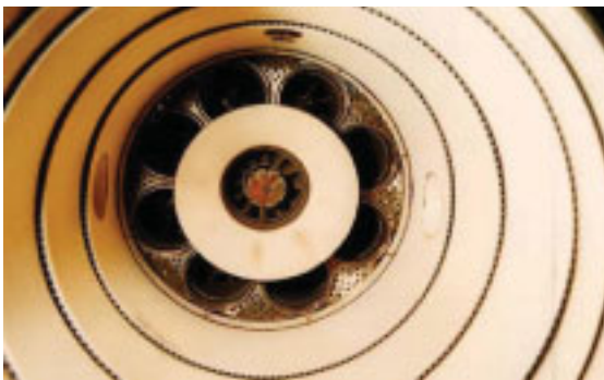
Rohrbrennkammer (Sicht auf Drallerzeuger)
