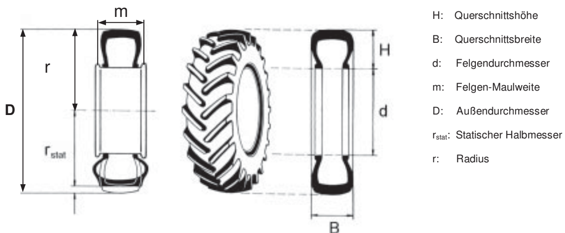
Abb. 2-2: Wichtige Reifenabmessungen für die Reifenkennzeichnung (SEUFERT, 2004)
