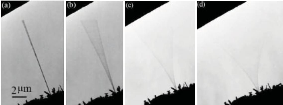
**Abbildung 2.1:** TEM-Aufnahme eines ZnO-Nanodrahts in resonanter mechanischer Schwingung entnommen der Referenz [34].
