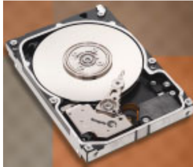
Abbildung 1.1: Bild einer typischen, auf magnetischer Datenspeicherung basierenden Festplatte (Seagate), wie sie in heutigen PCs verwendet wird.
