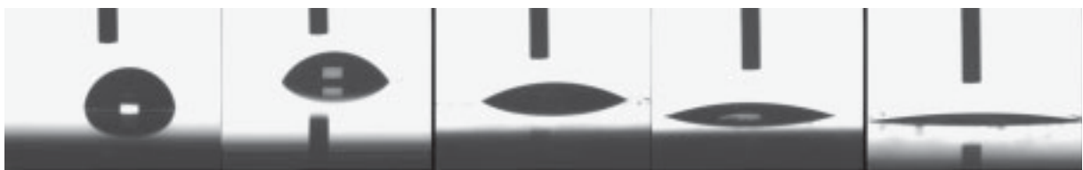
Abbildung 1.1: Verlauf des Kontaktwinkels unter UV-Bestrahlung; von einem Kontaktwinkel von \sim 80^\circ (links) zu einem Winkel von \sim 2^\circ (superhydrophil, rechts).
