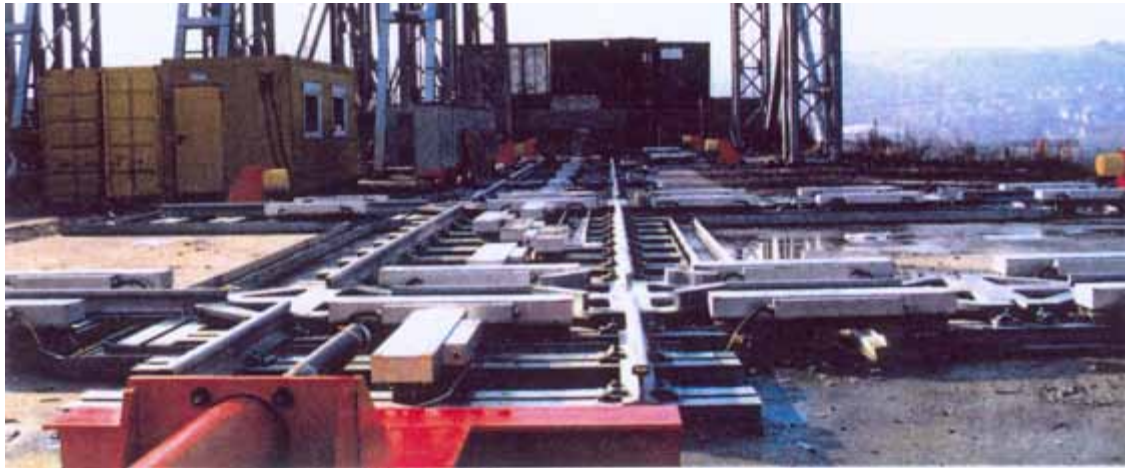
Abbildung 1.1: Fahrweg eines Containerhandlingsystem mit Linearantrieben (Quelle: Noell Crane Systems)
