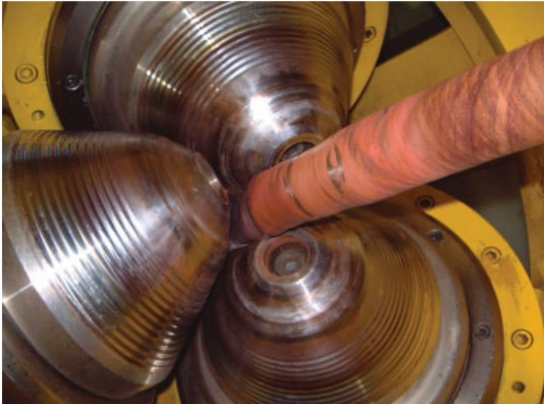
Abbildung 2-3: Walzen eines PSW mit Kupferluppe
