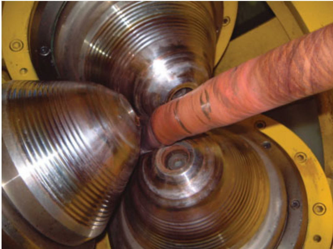
Abbildung 2-3: Walzen eines PSW mit Kupferluppe
