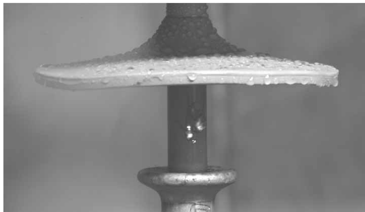
Abbildung 0.1: Leuchterscheinungen der Wassertropfenkorona am Strunk eines Verbundisolators
