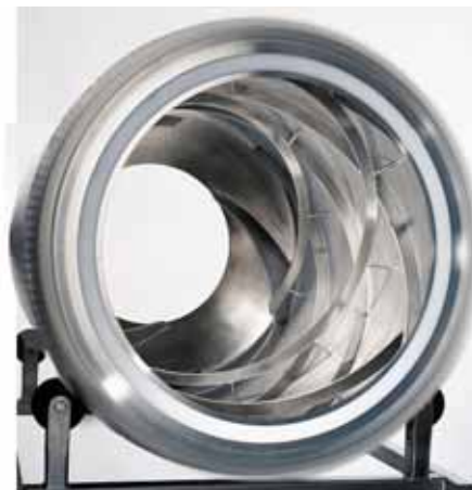
Abbildung 1.2: Darstellung der Mischelemente in der Trommel des BFC 40
