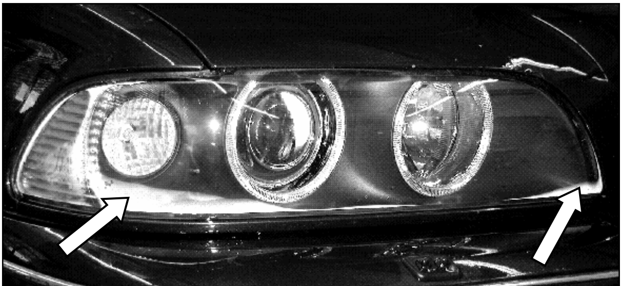
Abbildung 1.1: Kondensatbildung auf der Innenseite der Abschluss-Scheibe eines Kfz-Scheinwerfers
