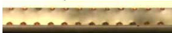
Bild 2: Beidseitig optisch funktionalisiertes Dünnglas mit Wellenleiterdimensionen von ca. 53 µm x 110 µm hergestellt durch Silberionen-Austausch mit einer Salzschnmelze.
