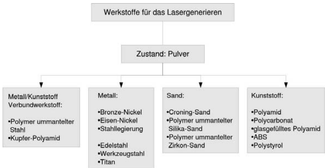
Abbildung 2.5: Werkstoffsysteme für das Lasergenerieren aus pulverförmigen Ausgangsmaterialien
