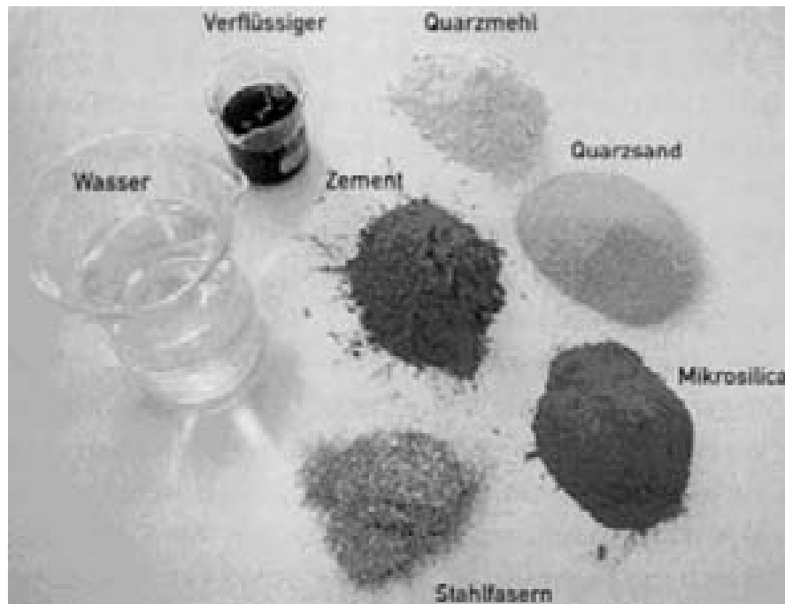
Bild 1.8: Mischungsbestandteile eines ultrahochfesten Betons [Schneider, Horvath, König und Dehn (2001)]
