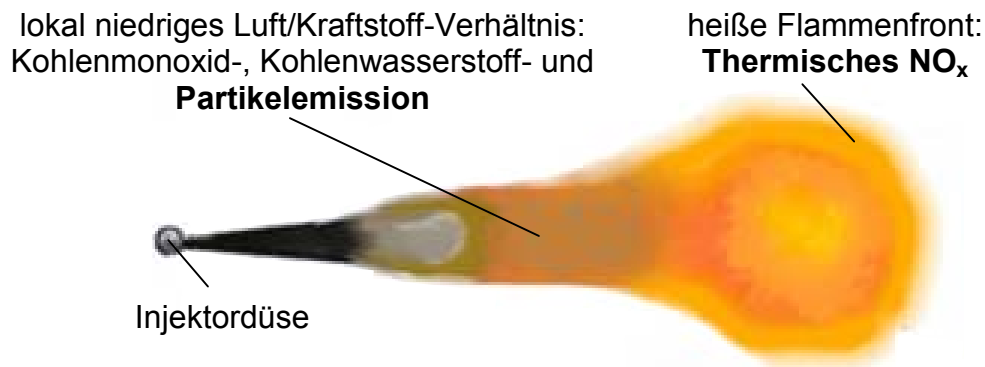
Bild 2.1: Flammenausbildung bei heterogener Dieselerbrennung [DWF99]
