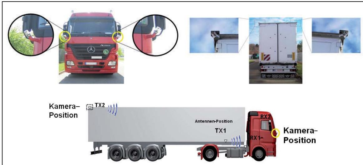
Abbildung 1-4: Kamera-Positionen und mögliche Antennen-Positionen an einem LKW
