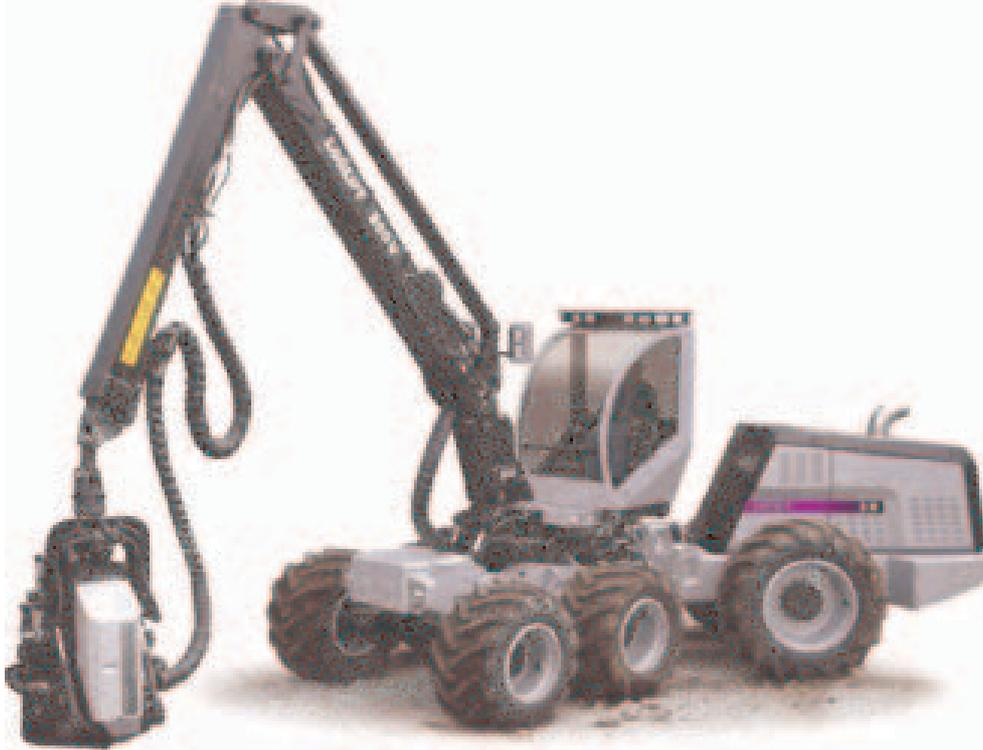
**Bild 1:** Durch Mobilhydraulik angetriebene Holzernemaschine, Quelle: [NN-03b]
