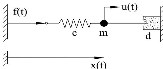
Abbildung 1.1: Feder-Masse-Dämpfer-Schwinger
