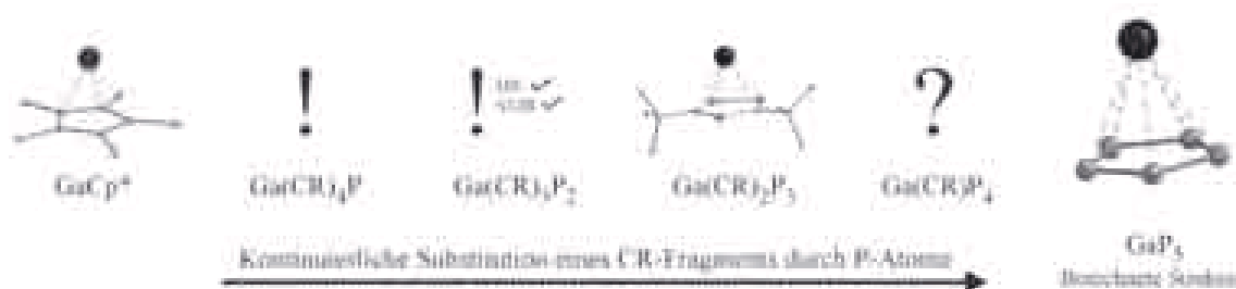
Schema 1: Bisher dargestellte und erwartete „poly-hapto“ Verbindungen des Galliums als Variationen des Cp-Grundkörpers auf dem Weg zum \text{GaP}_5 .
