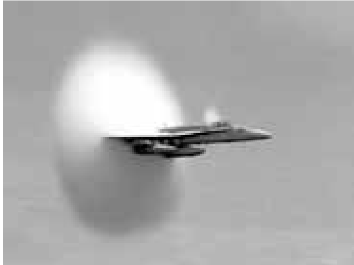
Abbildung 1.1: Ein Düsenjet bricht durch die Schallmauer. Durch die besonderen Druckverhältnisse bilden sich Wassertröpfchen (Quelle: www.nasa.gov ).
