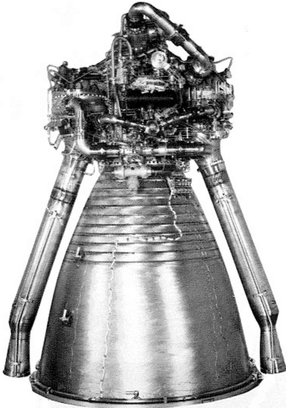
**Bild 1.1:** HM60-Vulcain-Triebwerk der Ariane 5 (Quelle: Deutsches Zentrum für Luft- und Raumfahrt e.V., Institut für Raumfahrtantriebe, Lampoldshausen)
