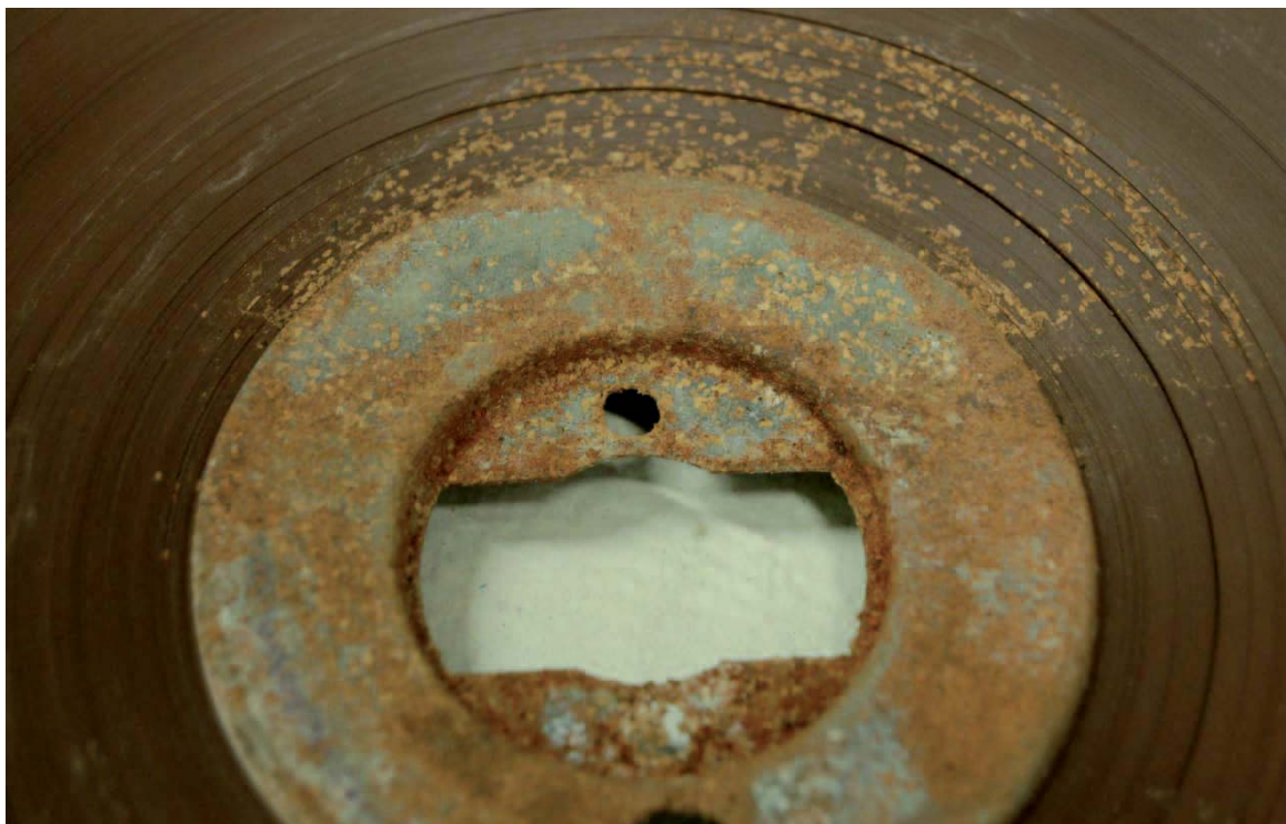
Abb. 5: Durch Wasserschaden korrodierte Ablagerungen an Wickelkern und Tonband. Foto: Nadja Wallaszkovits.
