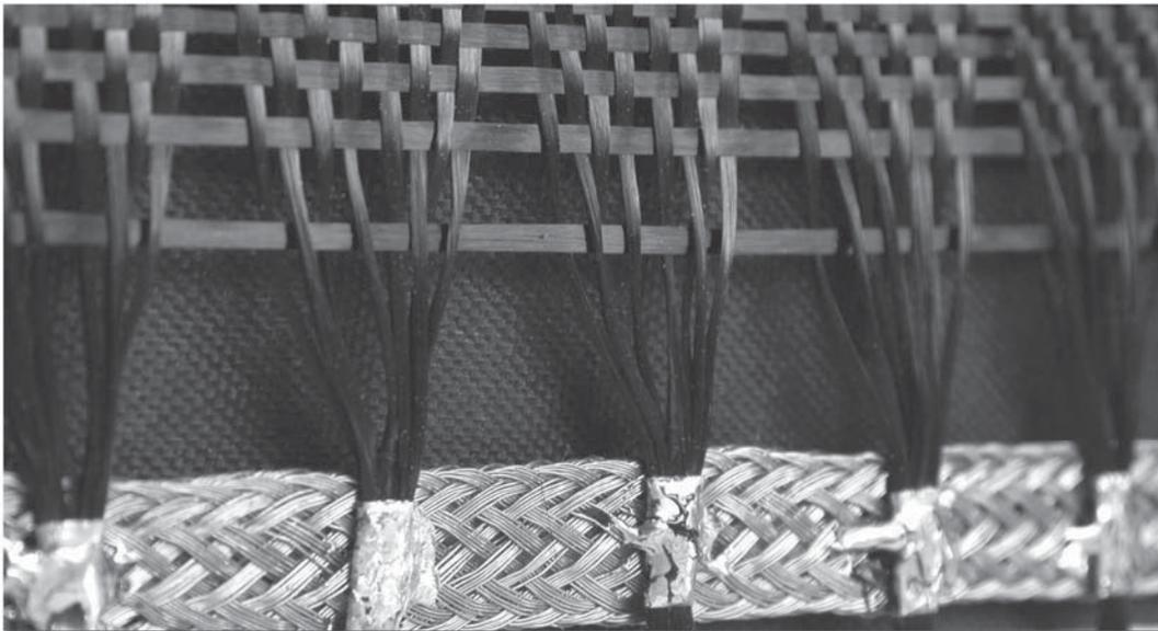
**Bild 2.5:** Kohlenstofffasergewebe mit elektrisch leitfähigen Anschlüssen [Bildquelle: FIBRE-TEMP (2009-01)]
