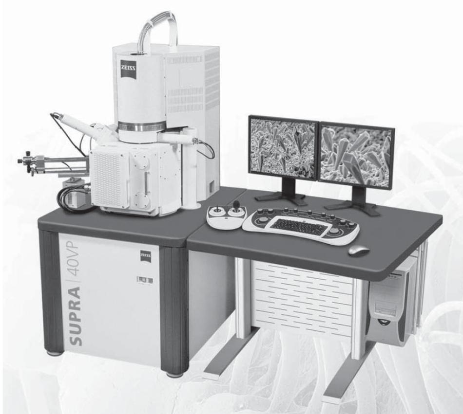
Abbildung 2.2: Repräsentatives Photo eines Zeiss Supra® 40 VP.<sup>[55]</sup>
