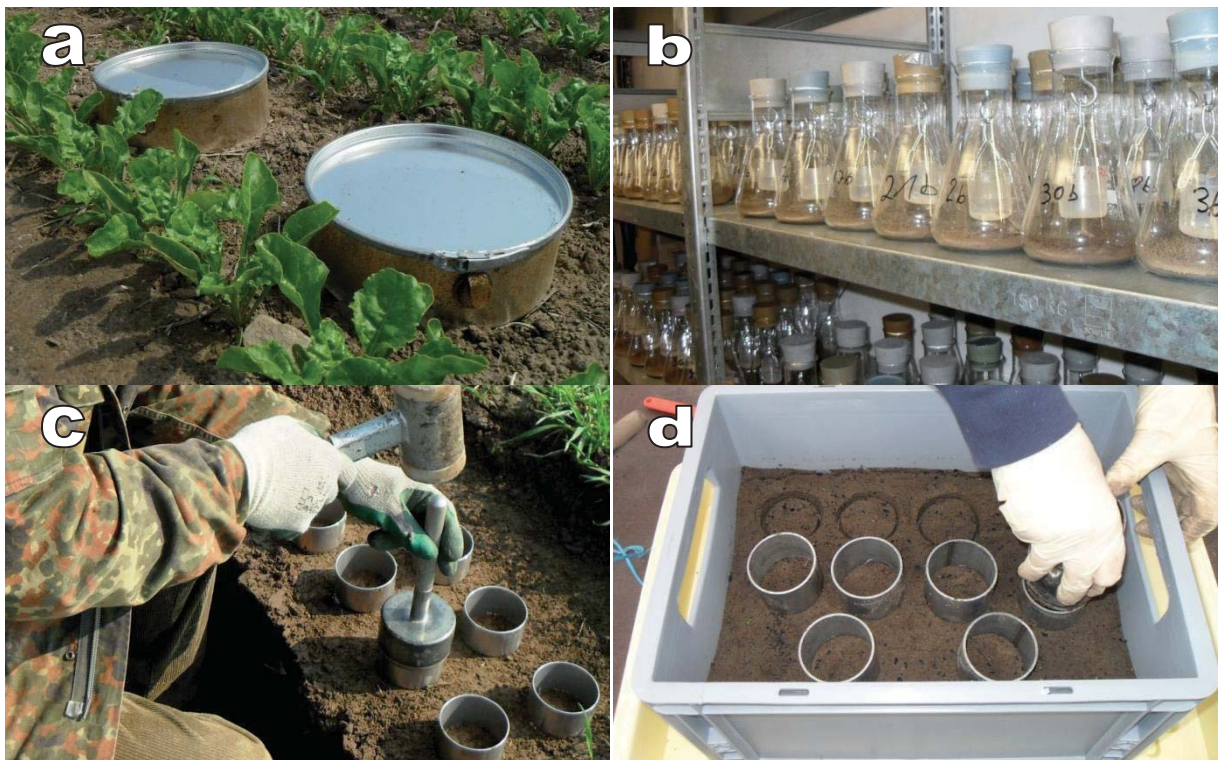
Abb. 5. Messung der Kohlenstoff-Freisetzung mittels Natronlauge-Methode (a, b) bzw. Bodenprobenahme mittels Stechzylinder für die Bestimmung der Wasserhaltekapazität (c, d) unter Feld- und Laborbedingungen
