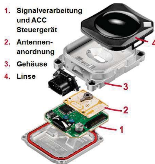
Abbildung 3.3: Explosionsdarstellung des LRR3 aus Lucas (2009)
