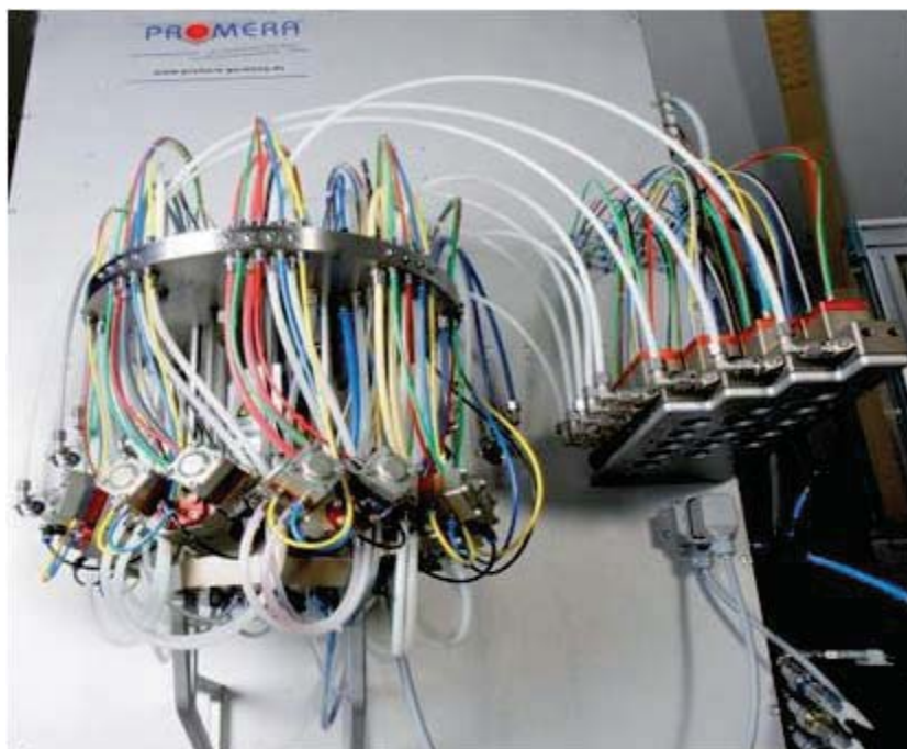
Abbildung 3-8 Sternmischkopf in der Vielfarbenanlage [49]
