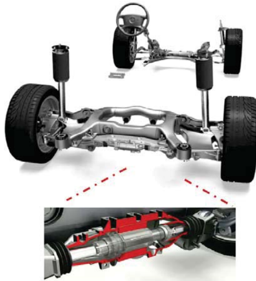
Bild 2.1: Hinterradlenkung im BMW 7er [115]
