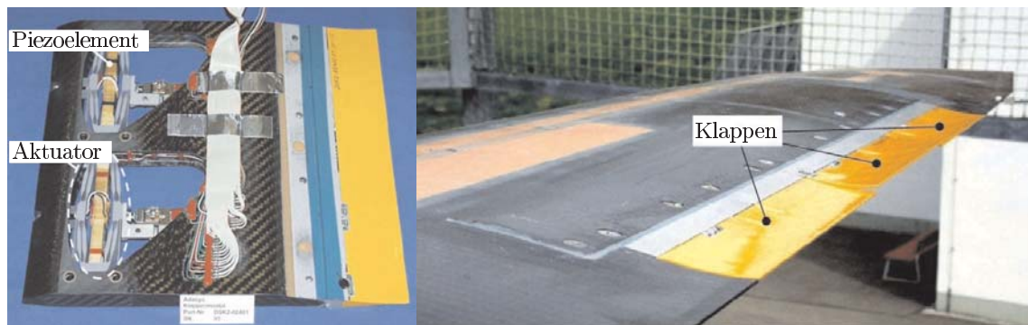
Abbildung 2.5: Abbildung des Rotorblattklappenmoduls nach [23]
