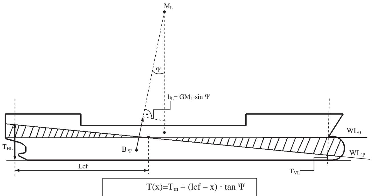
Diese Gleichung ist so angelegt, dass das Schiff um den WL-Schwerpunkt dreht
