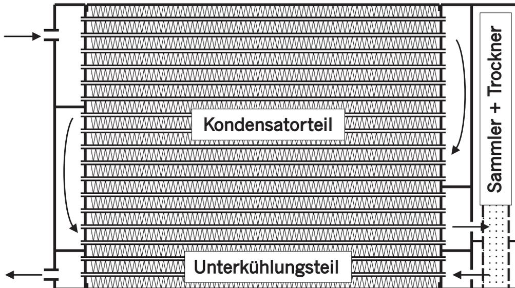
Abbildung 2.4: Aufbau R134a-Kondensator-Modul.
