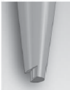
Aufnahme von „blue tape“: Ausstechnadel kippt TFE
