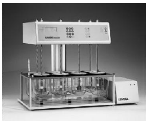
Figure 1.3.1 USP apparatus II (Paddle)
