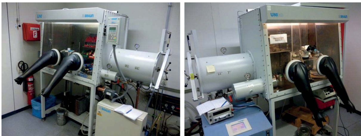
Abbildung 2. Handschuhkasten vom Typ UNILab der Firma Braun (links) und Schutzgasanlage (rechts).
