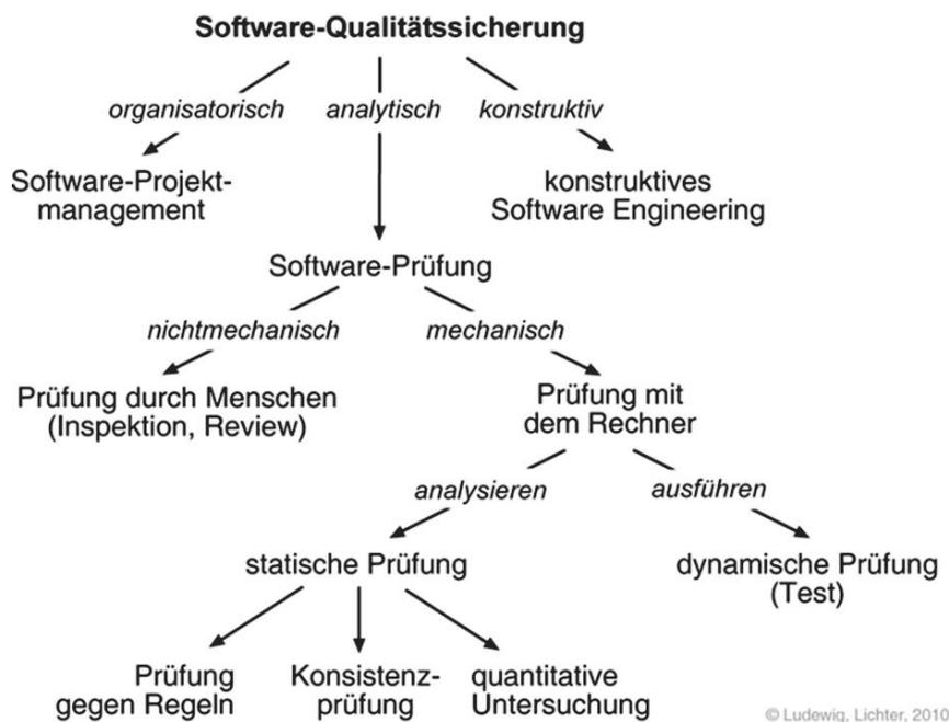
Abbildung 1: Übersicht über die Prüfverfahren nach [LL10]
