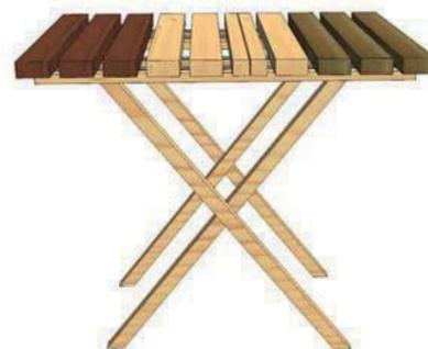
Abbildung 8: COST Action FP 1303: Links Logo der Action. Rechts: Prinzipskizze des „Performance Table“, ein an 25 Standorten in Europa exponiertes Prüfgestell zur Bewertung der Performance von Holz.
