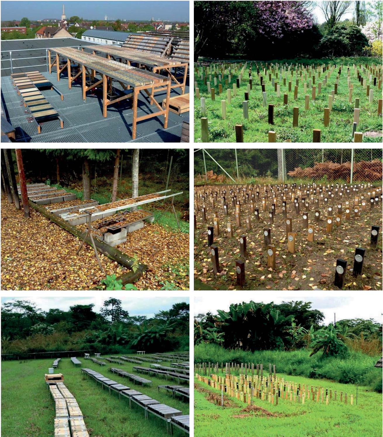
Abbildung 7: Prüffelder für Holz ohne (links) und mit Erdkontakt (rechts). Von oben: Hannover-Herrenhausen, Deutschland; Borås, Schweden; Hilo, Hawaii, USA.
