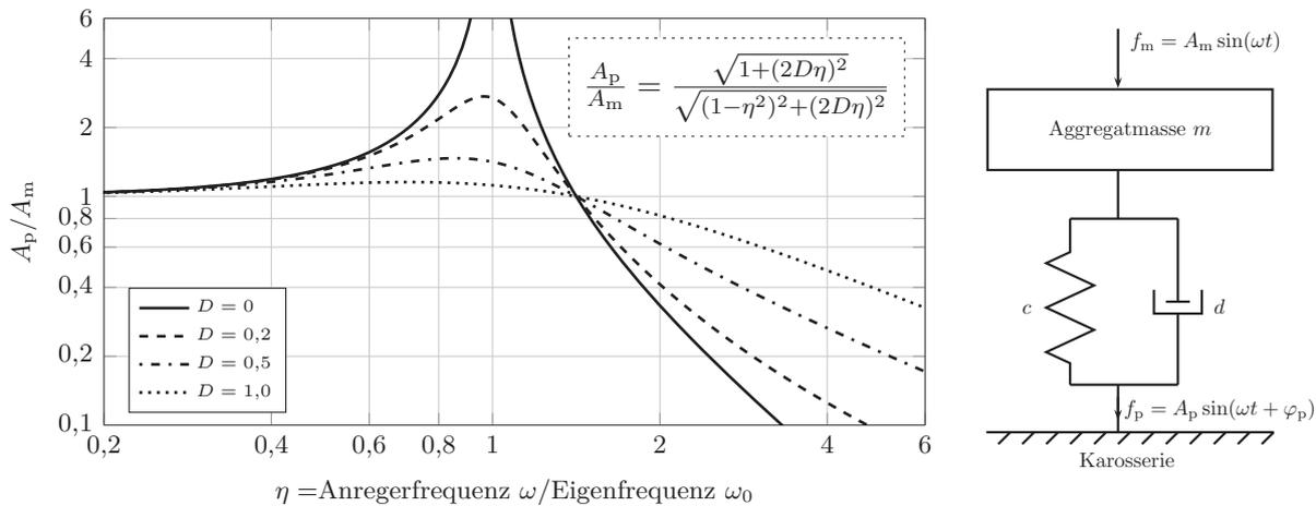
**Abb. 1.1:** Amplitudengang der Kräfteinleitung in die Karosserie [72, 215, 216].
