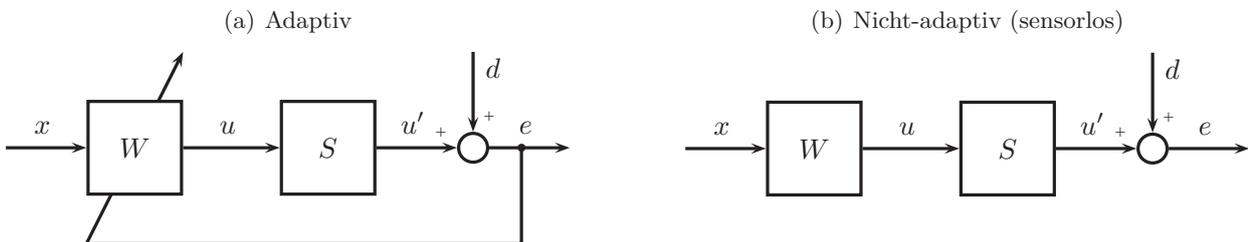
**Abb. 1.2:** Verfahren zur Steuerung aktiver Motorlager
