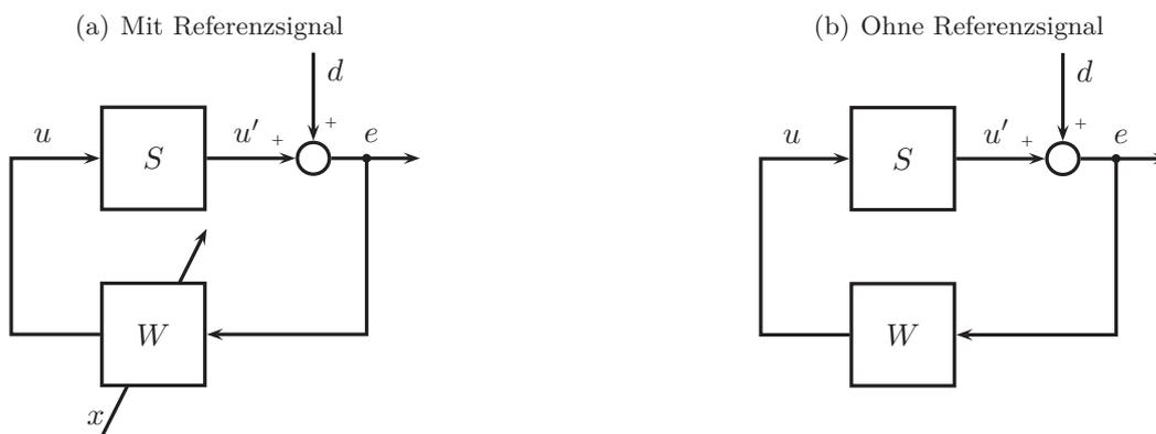
**Abb. 1.3:** Verfahren zur Regelung aktiver Motorlager
