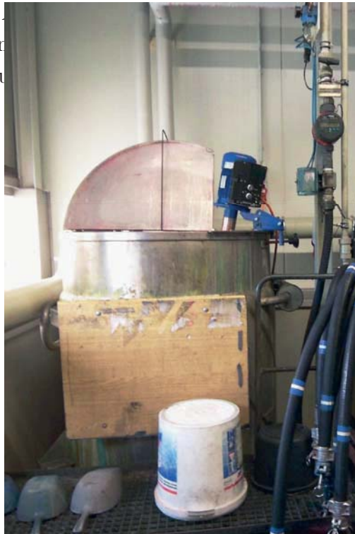
Abb. 2.3 Beispiel eines zur Produktion von Fasermalern verwendeten Rührkessels [18]
