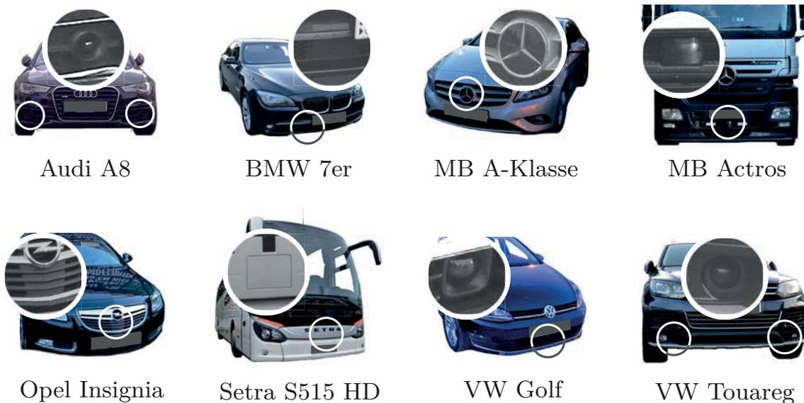
**Abb. 2.2:** Im Fahrzeug integrierte Radarsensoren (Bildquelle: Aufnahmen des Autors).
