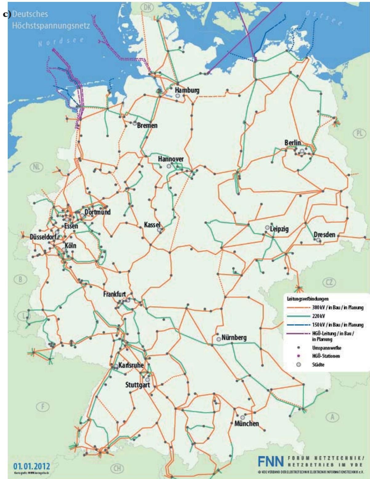
Abbildung 2-2: Historische Entwicklung des Stromverbundnetzes: c) Deutsches Höchstspannungsnetz in 2012
