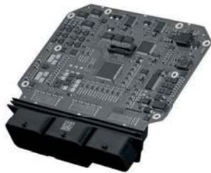
(a) Beispiel eines Steuergeräts (ECU)
